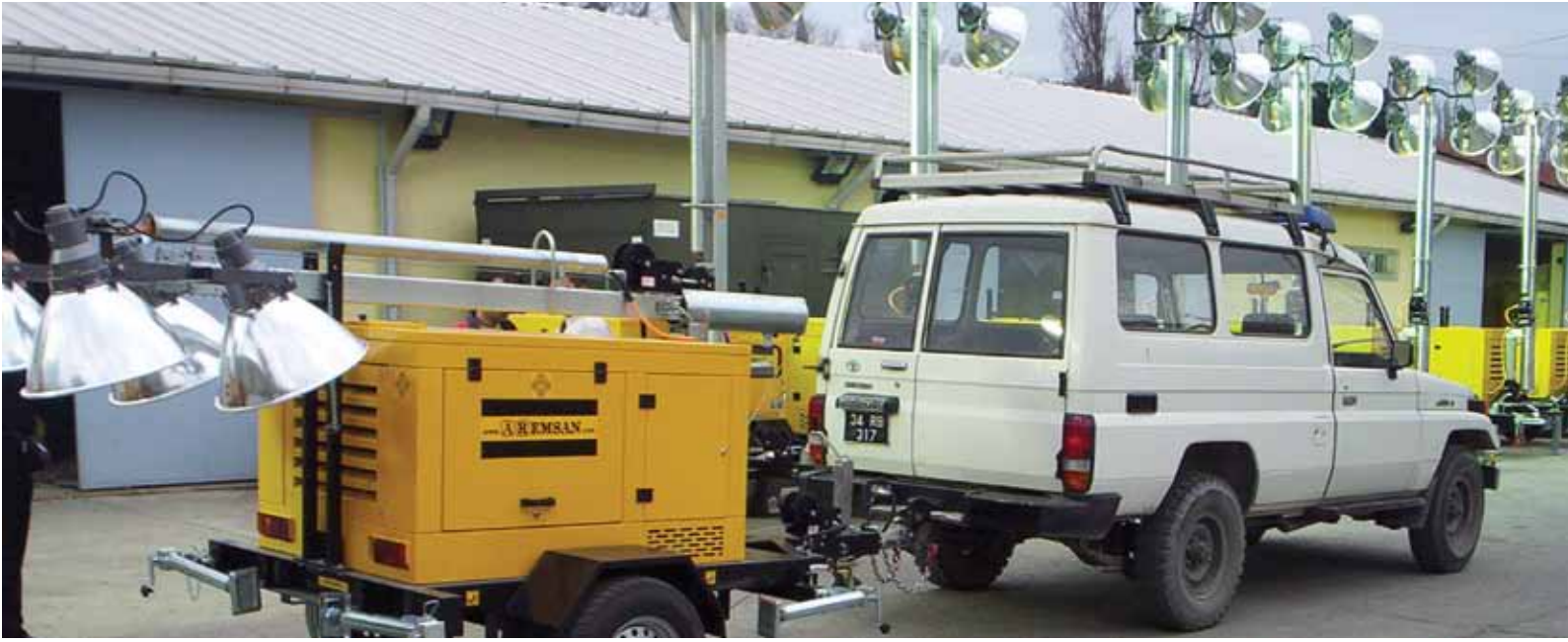
Mobil Jeneratör ve Işık Kuleleri
