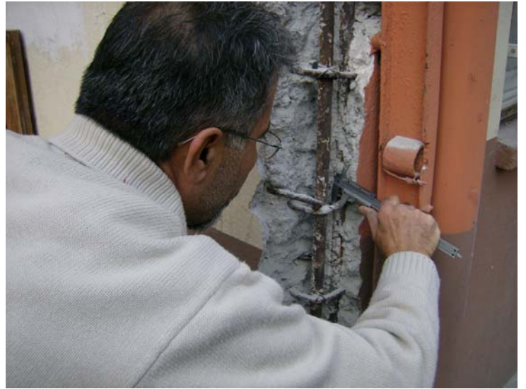
Şekil 5.4. Pas payı sıyrılarak belirlenen kiriş ve kolon donatısı ve detayları
