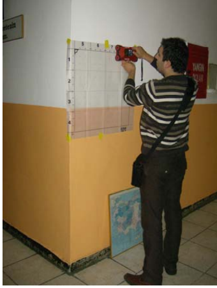
Şekil 5.3. Ferroskan cihazı ile betonarme duvar yüzeyinde tarama yapılması ve tarama sonucu
