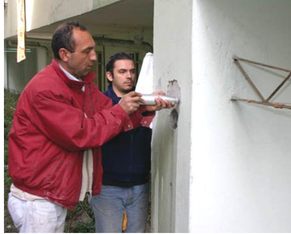
Şekil 5.5. Schmidt darbe çekici ile yüzey sertliği değerinin okunması
