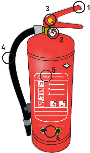
Şekil 3.2: Yangın söndürücünün bileşenleri
