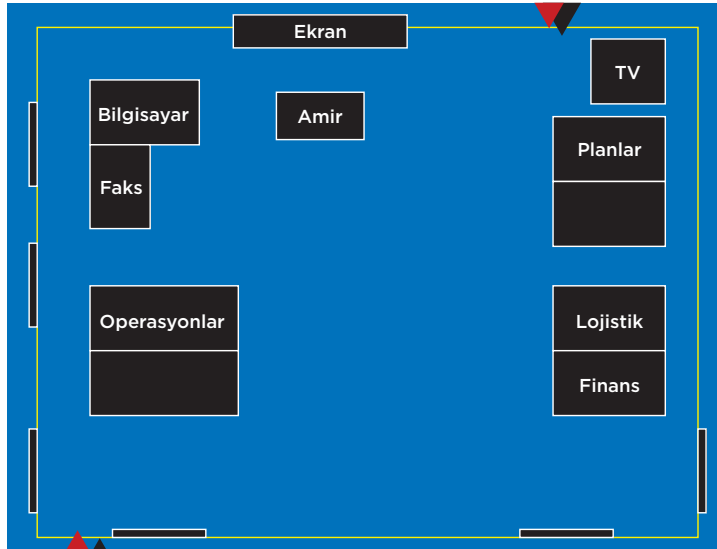
Şekil 27. İşyerlerinde Olay Komuta ve Karargâh Servisi'nin çalışacağı Afet ve Acil Durum Yönetim Merkezi'ne örnek tasarım.
